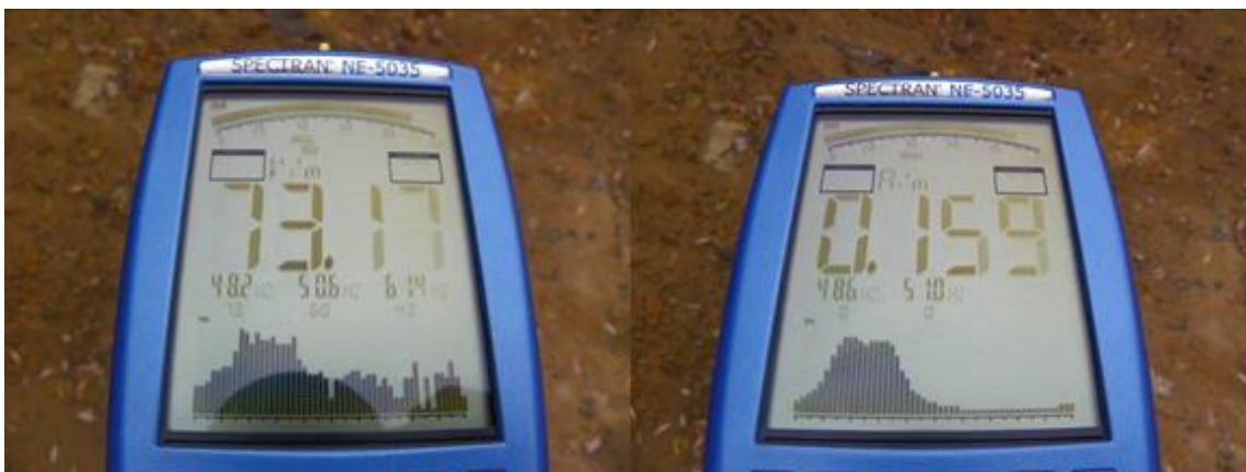
Fot. 10 Pomiar składowej elektrycznej (na lewo) i składowej magnetycznej (na prawo) w punkcie pomiarowym zlokalizowanym w odległości ok. 5 m od transformatora średniego napięcia [fot. Krzysztof Kręciproch]
