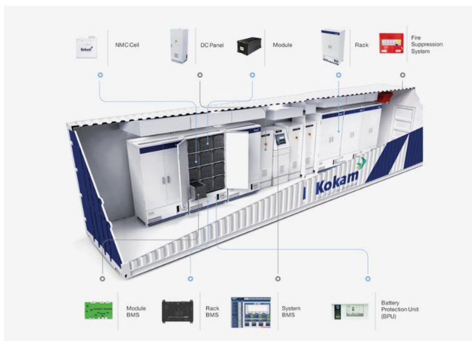
Rys. 17 Przykładowy Kontenerowy magazyn Energii
